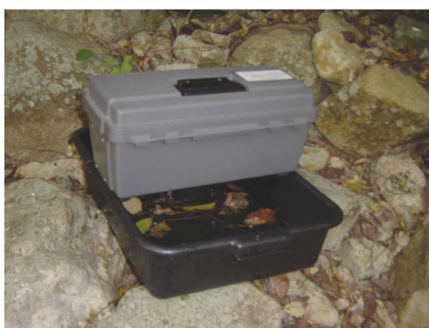
圖2.38：蚊蟲採集器(Gravid trap)
