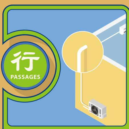
在裝置好管道、 電線或分體式冷氣機 後密封在外牆、 地板及屋頂留下的洞
