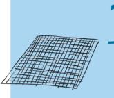
化糞池的排氣管及其他氣孔已裝上蚊網,以 防止蚊子飛入(每平方厘米有30至40個網孔 的蚊網可阻隔大部分蚊子);
